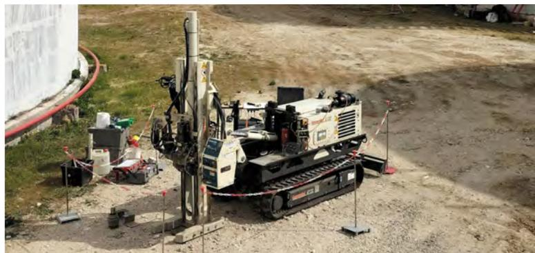
*Geoprobe 6712DT®, strumentazione per il campionamento delle differenti matrici ambientali*
